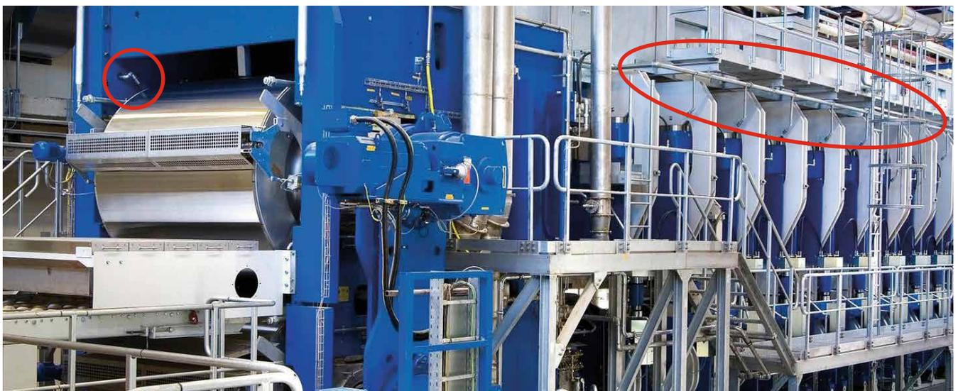
Abb. 9: Spanplatten Form- und Pressenstation inkl. Löschanlagenschutz (siehe markierte Bereiche)
