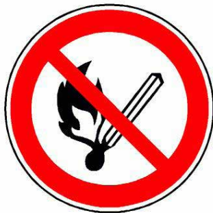
Keine offene Flamme; Feuer, offene Zündquelle und Rauchen verboten (Kennzeichen P003)
