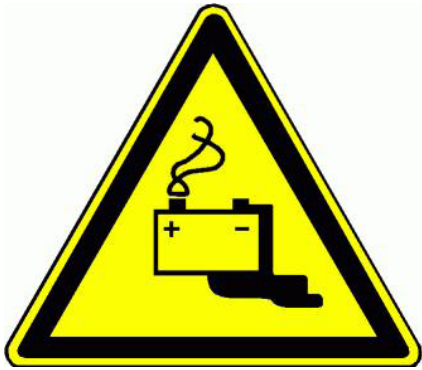
Warnung vor Gefahren durch das Aufladen von Batterien (Kennzeichen W026)
