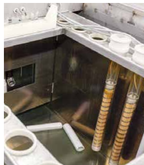
Abb. 7a: Heizelemente mit thermischen Verfürgungen der Heizpatronen und elektrischer Kabel.
