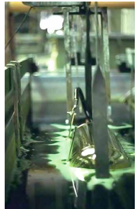
Abb. 3: Elektropolieren eines Werkstücks unter Wasserstofffreisetzung. Das Verfahren wird vor allem bei Edelstählen zum Einebnen von Oberflächen eingesetzt. Nach dem Eintauchen in starke Säuren werden die Werkstücke als Anode geschaltet, dabei werden metallische Unebenheiten im Mikrobereich elektrochemisch abgetragen, sodass eine glatte und glänzende Oberfläche entsteht. Hierbei werden Stromdichten bis zu 100 \text{ A/dm}^2 angewendet.
