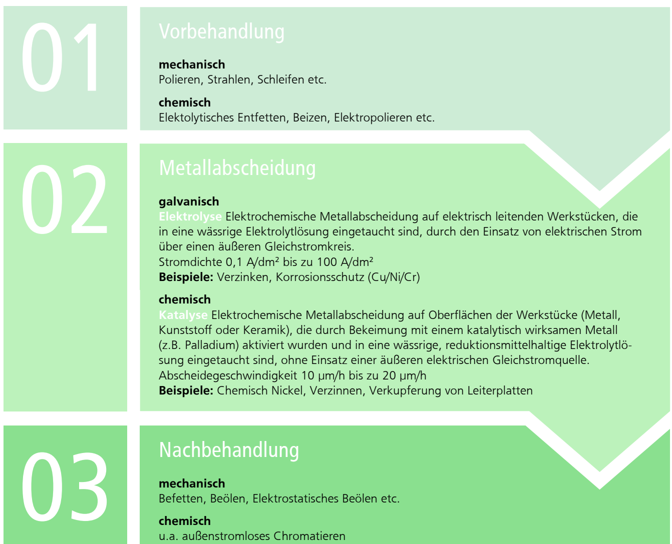
Abb. 4: Grundlegende Prozessschritte des galvanotechnischen Verfahrens.
