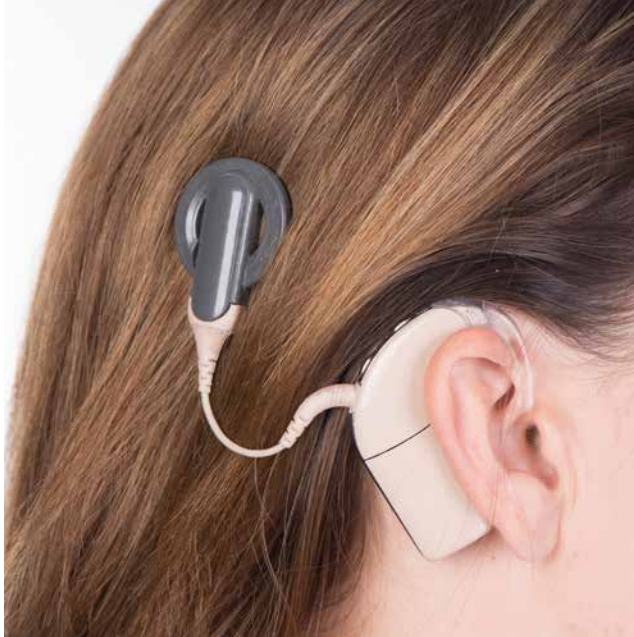
Cochlea-Implantat für Gehörlose, deren Hörnerv noch funktioniert
